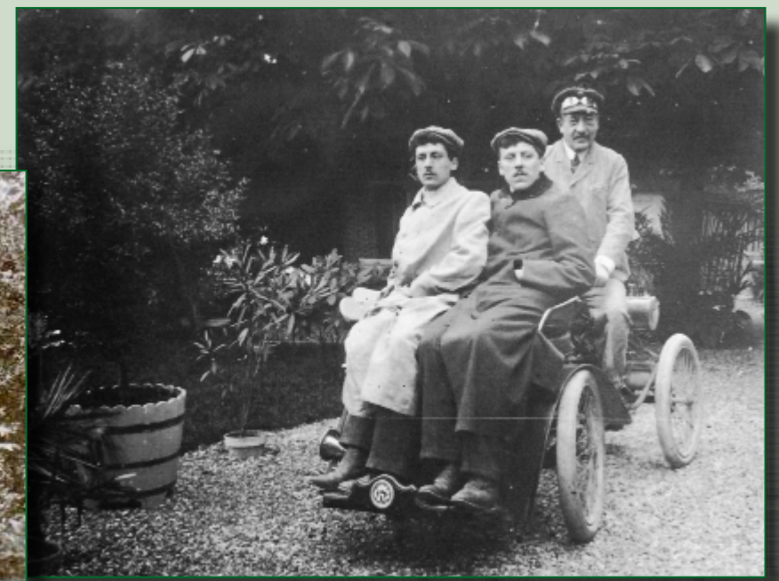
3 - Cette SONCIN quadricycle, voiture routière de 1901, appartient à la famille Renaud, ici dans la cour de leur maison rue de Sévigné en 1920. Les passagers sont assis à l'avant, le conducteur dirige le véhicule depuis l'arrière.
